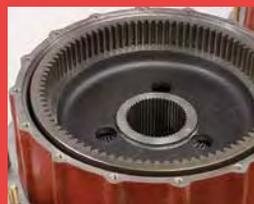
При снятии крышки главной передачи, открывается доступ к планетарной и солнечной шестерням.
