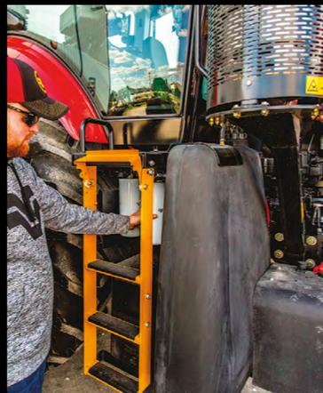
Лестница с правой стороны обеспечивает быстрый доступ к воздухоочистителю двигателя для его обслуживания. Лестница также помогает при заправке топлива с правой стороны, обеспечивает доступ к входной двери и легко складывается, когда не используется.
