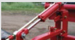
Легко регулируемое устройство штифтового типа для контроля высоты катка и транспортировочный замок
