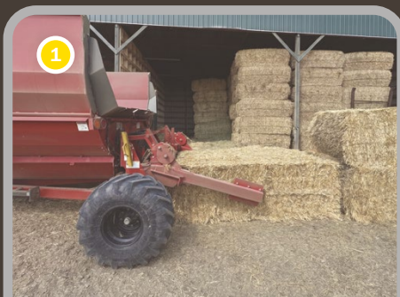
1 Загрузочные вилы-клевши захватывают тюк и поднимают его прямо вертикально.
