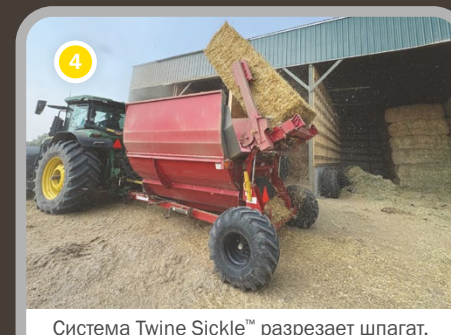
4 Система Twine Sickle™ разрезает шпагат, после чего тюк свободно падает в камеру. Разрыхленная структура тюка обеспечивает более равномерную и быструю переработку.
